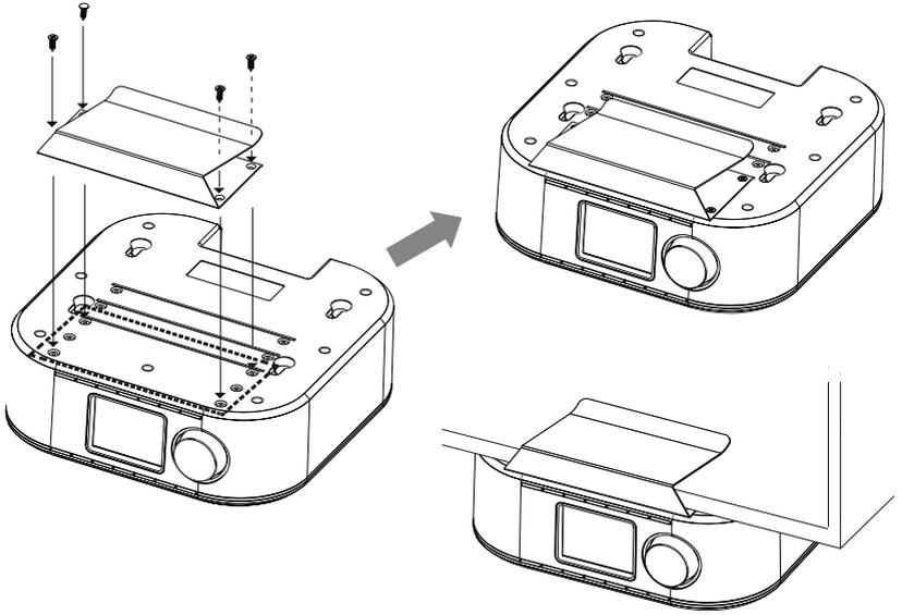
5.4 Συναρμολόγηση με σύστημα βύσματος
