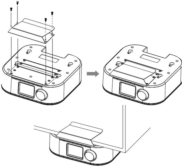
**C** Mounting with connector system / Montage mit Stecksystem
