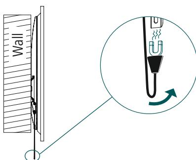
Краищата на предпазните въжета могат да бъдат прикрепени към задната част на стенната стойка с помощта на магнитите.
