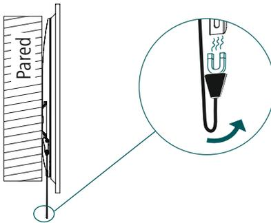
Los extremos de los cordones de seguridad pueden fijarse tras el soporte de pared con ayuda de los imanes.
