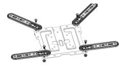
• Monte as placas adaptadoras na placa VESA utilizando os parafusos [F1] e as porcas roscadas [F2], conforme ilustrado. Para o efeito, utilize a chave inglesa [G1].
